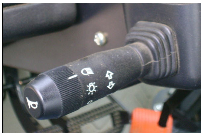
Figura 14: Detalhe do comando de iluminação. Pelo seu posicionamento espacial pode ser interpretado como “para cima” o que o torna compatível com o estereótipo popular.
