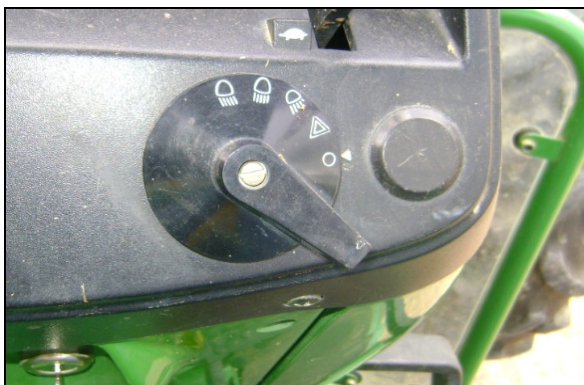
Figura 8: Detalhe do comando de iluminação. A forma do manípulo induz ao movimento “para cima” em oposição ao movimento no sentido horário, que é compatível com o estereótipo.
