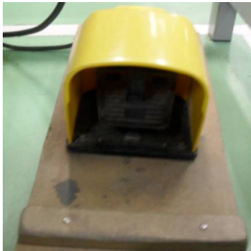
Figura 08: pedal com trava de segurança
