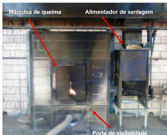
Figura 2. Máquina de queima com alimentador de serragem.
