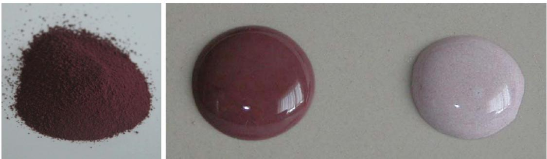
**Figura 9.** Cor desenvolvida pelo pigmento Ma-C calcinado a 1450°C (esquerda) e por vidrados contendo 5% (em peso) de pigmento: VTB (centro) e no VOB (direita), calcinados a 1050°C.
