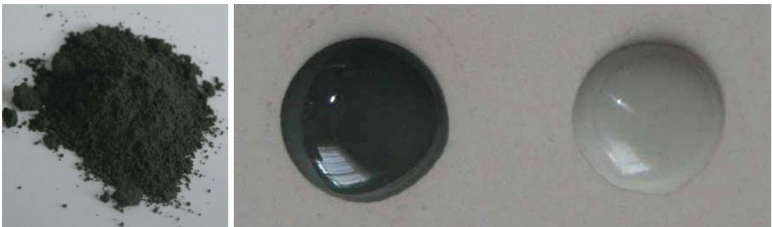
**Figura 7.** Cores desenvolvidas pelos pigmentos calcinados a 1000°C (esquerda) e por vidrados contendo 5% (em peso) de pigmento: VTB (centro) e no VOB (direita), calcinados a 1050°C.
