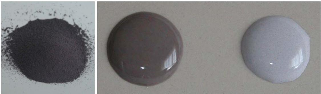
**Figura 8.** Cor desenvolvida pelo pigmento Ca-C calcinado a 1450°C (esquerda) e por vidrados contendo 5% (em peso) de pigmento: VTB (centro) e no VOB (direita), calcinados a 1050°C.
