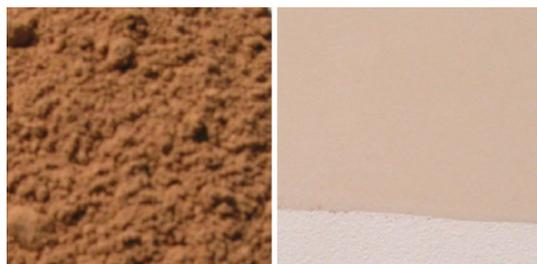
**Figura 6.** Cores desenvolvidas pelo pigmento Cc-AF calcinado a 1300°C (esquerda) e por um vidrado transparente brilhante, isento de chumbo, aplicado em condições industriais (calcinado a 1080°C, com ciclo de 60 min), ao qual se adicionou 5% de pigmento.
