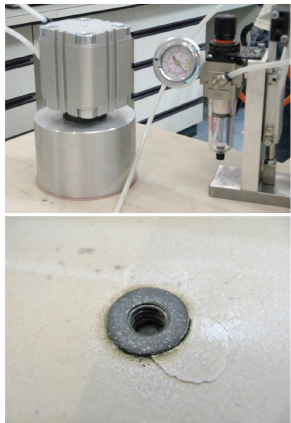
**Figura 12.** Sistema de ensaio e inserto após o ensaio de extração (à direita).
