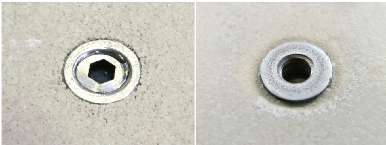
**Figura 6.** Insertos antes (à esquerda) e depois da queima (à direita); pode ser observado (à esquerda) o parafuso “prisioneiro”, retirado logo após a queima (à direita).
