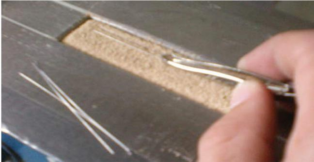
Figura 2. Aplicação das fibras na etapa de conformação.
