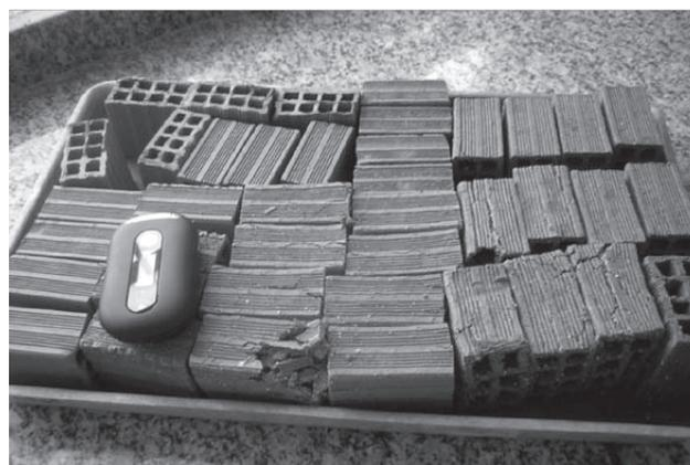
Figura 5. Falência estrutural dos tijolos.
