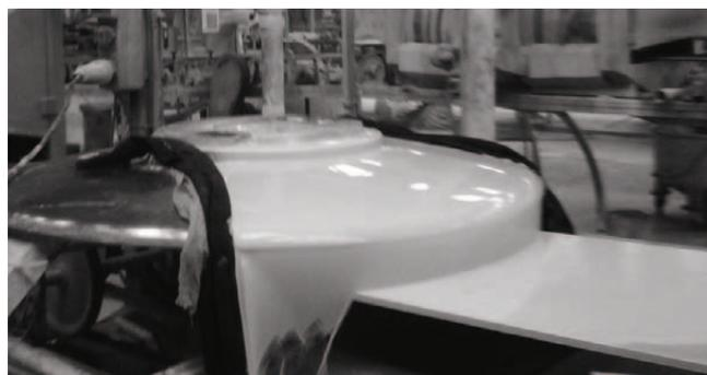
Figura 1. Aplicação de granilha em suspensão por campana.
