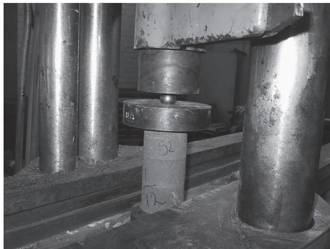
Figura 3. Ruptura de corpo de prova de solo-cimento.
