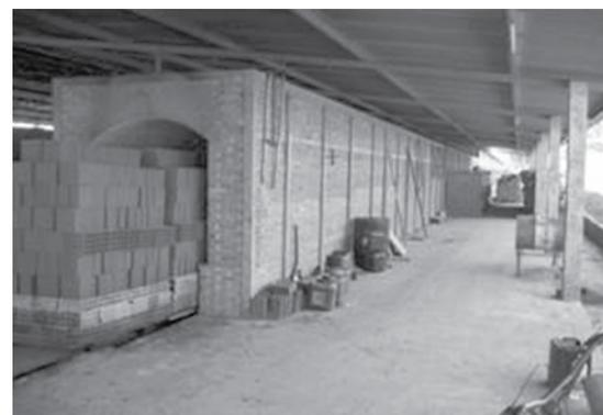
Figura 2. Vista do forno tipo contínuo tipo túnel da IC1; detalhe da vagoneta na saída da zona de resfriamento.
