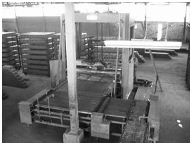
Figura 4. Sistema de automatismo para o empilhamento de blocos utilizado por uma das indústrias em estudo
