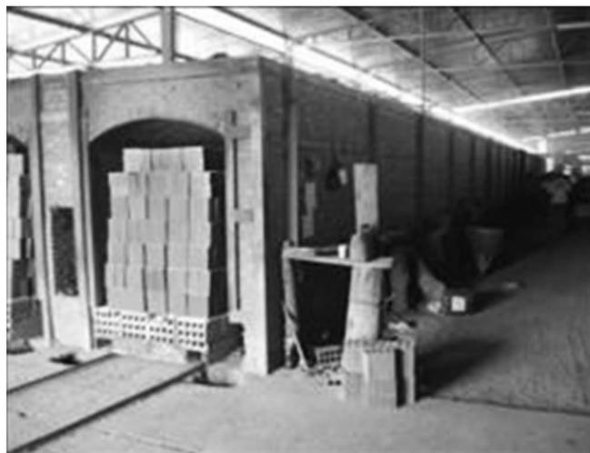
Figura 8. Forno contínuo de uma das indústrias em análise
