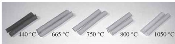
**Figura 4.** variação da cor de provetes cozidos do barro a diferentes temperaturas.
