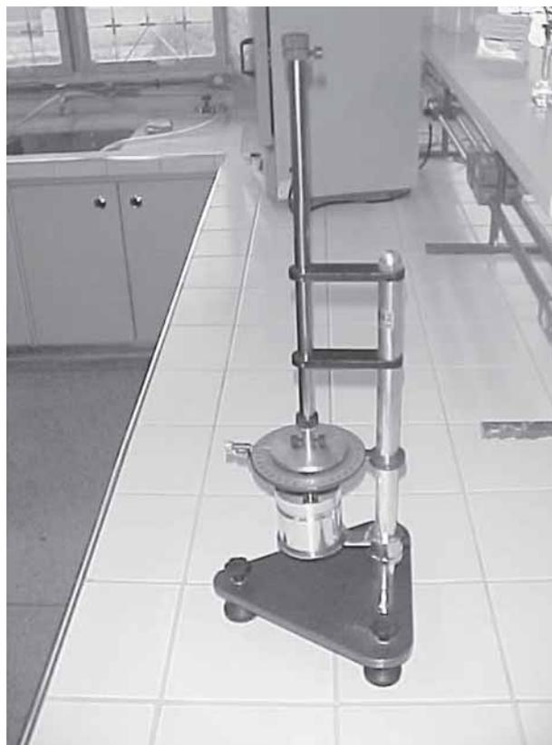
**Figura 2.** Viscosímetro de torção do Tipo gallenkamp desenvolvido no laboratório dos autores.
