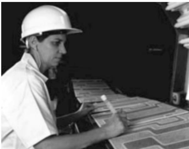
**Figura 1.** Inspeção final de peças cerâmicas Fonte: Itagres Revestimentos Cerâmicos.
