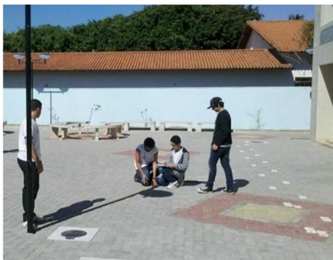
Figura 4: Cálculo da altura do poste medindo a altura da sombra do mesmo.
