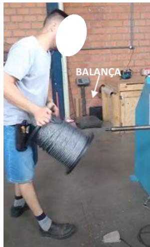
Figura 2 – Elevación de la bobina para pasar a la báscula
