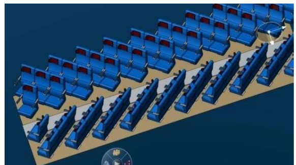
Figura 25 - Nueva distribución de asientos - vista lateral
