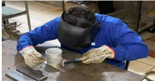
Figura 3 - Operador en la estación de trabajo realizando simulación de soldadura.
