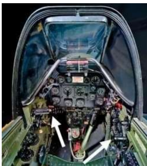
Figura 2 - Cabina de un P-51D. Las flecha muestran la palanca de potencia (izquierda) y la manivela de apertura.capó (derecha)
