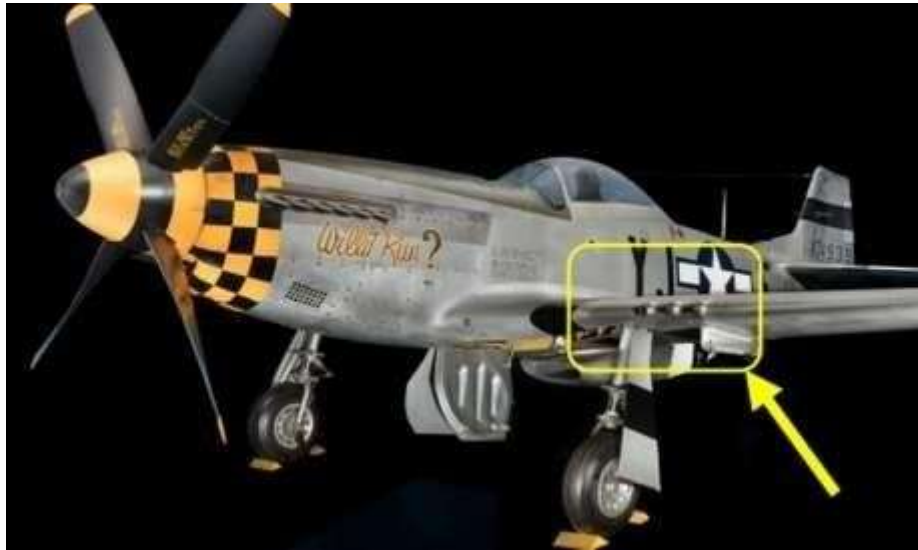
Cifra 3 - Apertura de ametralladoras en el alas de P-51D
