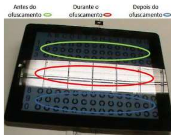
Figura 3 - Distinção das áreas da interface na programação do Matlab para a análise dos dados.
