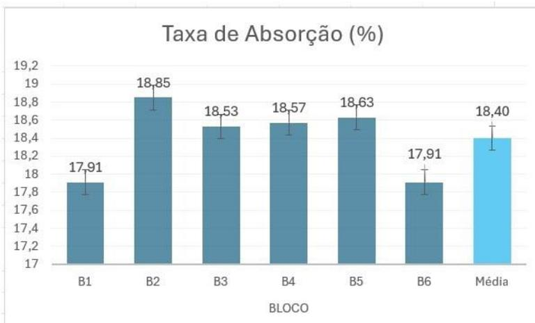
Figura 3. Taxa de absorção de água (%) dos blocos BCEPQ após imersão, conforme norma NBR 15270-1 [12]
