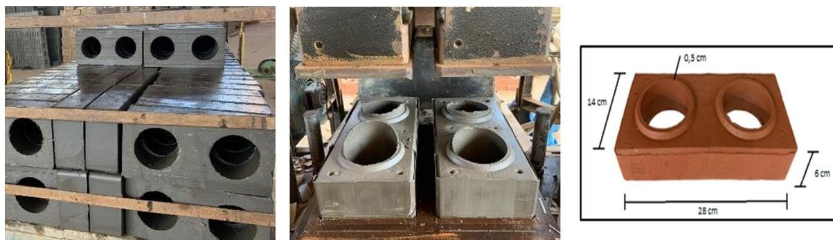
**Figura 1.** (a) BCEPQ ainda úmidos, após saída da etapa de extrusão; (b) Molde da prensa hidráulica com BCEPQ durante a etapa de prensagem; (c) Bloco após queima com indicação das dimensões nominais
