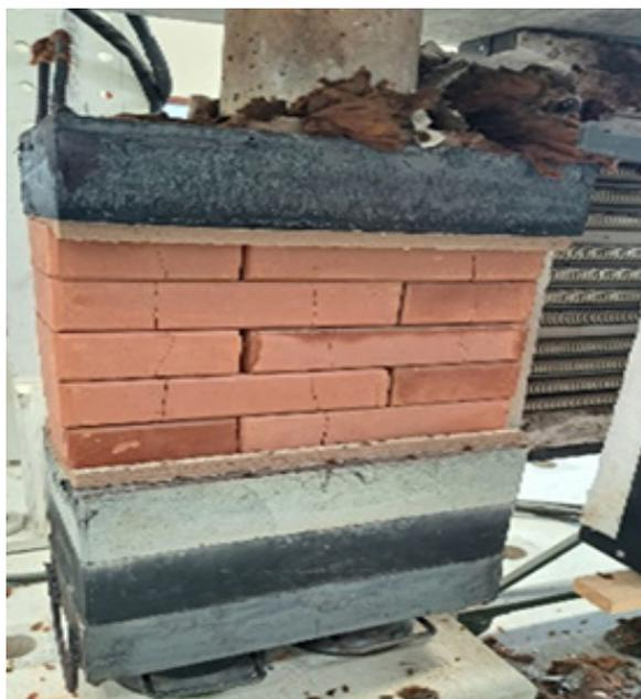
**Figura 7.** Prisma cerâmico rompido após ensaio de compressão simples, realizado imediatamente após exposição térmica a 600°C por 30 minutos.
