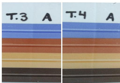
Figura 3. Formulação das bases serigráficas T3 e T4 aplicadas e queimadas em substrato cerâmico.
