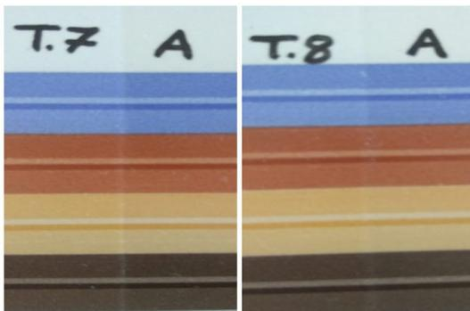
**Figura 5.** Formulação das bases serigráficas T7 e T8 aplicadas e queimadas em substrato cerâmico.
