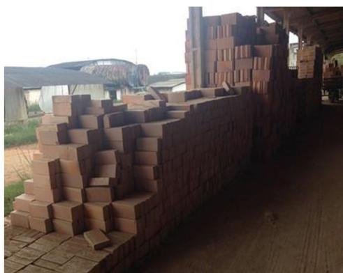
**Figura 7.** Reaproveitamento dos resíduos de produto não conforme (blocos maciços). Fonte: Autor (2017).
