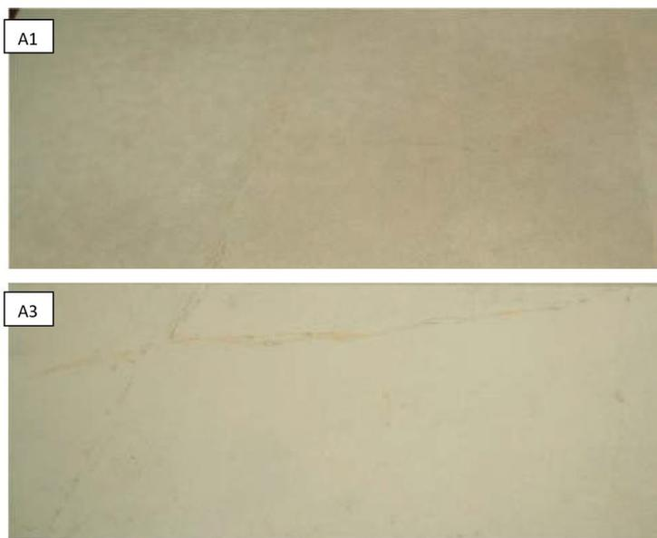
**Figura 3.** Imagem (fotos) de uma porção das placas A1 e A3 (15x5 cm) após a aplicação de uma solução contendo sujeira e sua remoção com um pano úmido.
