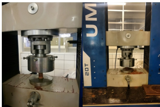
Figura 4. Ensaio de resistência à compressão com o equipamento 20T, UMC.
