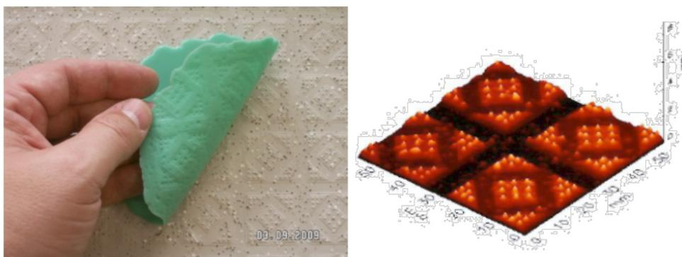
Figura 6. Técnica de réplica utilizada (esquerda) e visualização da duplicata (réplica) da superfície (direita, invertida).
