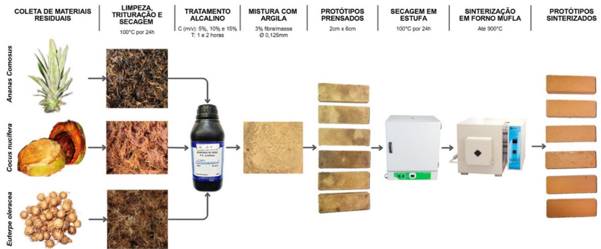
Figura 1. Fluxograma da incorporação de fibras de Ananas comosus , Cocos nucifera e Euterpe oleracea em cerâmica
