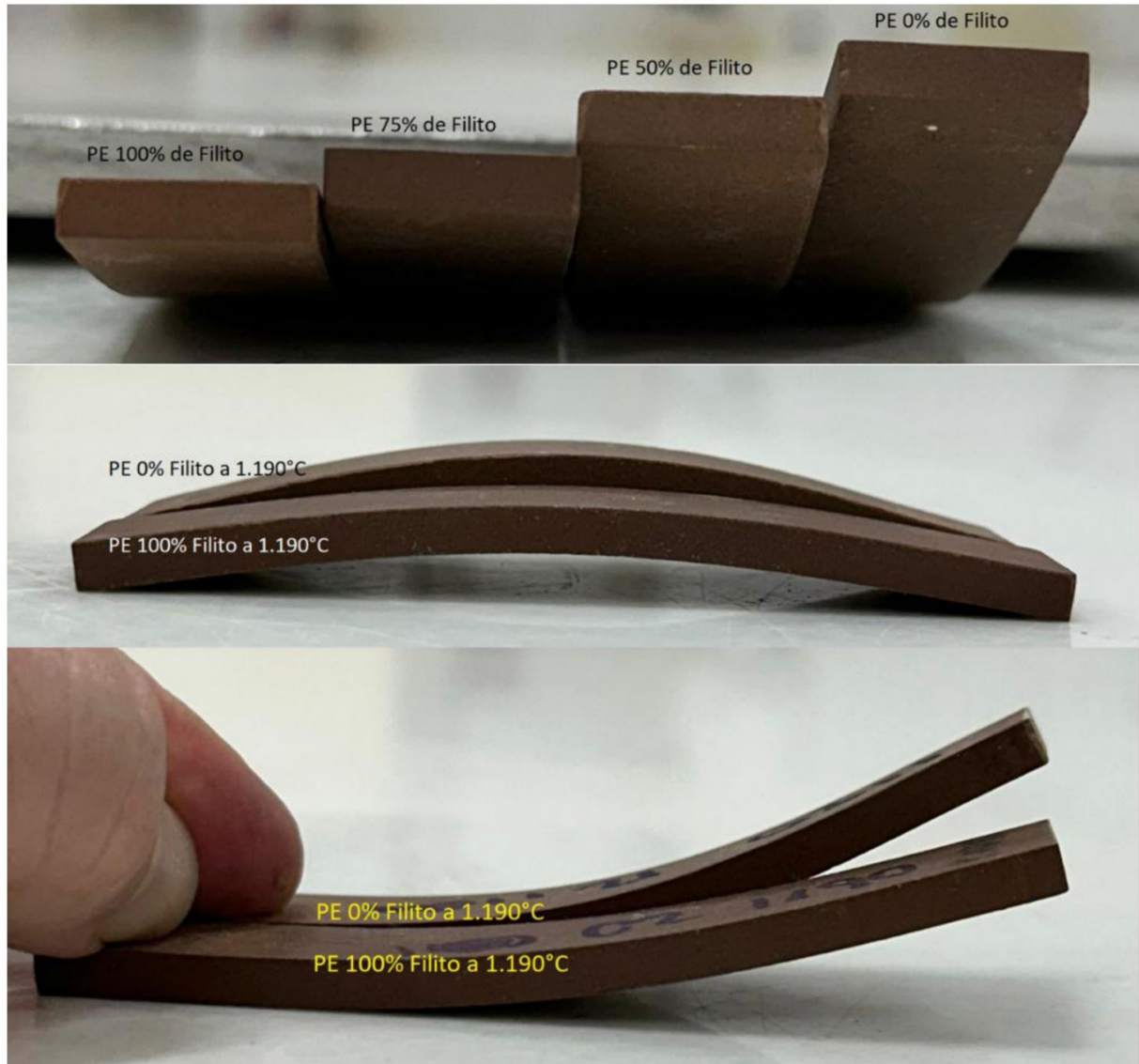
Figura 7. Curvaturas dos corpos de provas de cada composição, após ensaio de IP queimados a 1.190 °C
