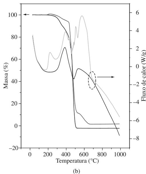
**Figura 4.** a) Curvas de massa em função da temperatura obtidas em atmosfera de N<sub>2</sub>/ar sintético (curvas pretas) e ar sintético (curvas cinzas) para o liner contendo diferentes cargas: (—) SA8, (---) SA8/GE8, (···) SA30, (----) SA30/GE8, (·-·-·) amianto; e b) Curvas de massa e fluxo de calor em função da temperatura para o PU em atmosfera N<sub>2</sub>/ar sintético (curvas pretas) e ar sintético (curvas cinzas).
