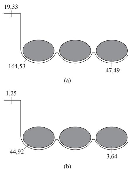
**Figura 3.** Valores de  $\text{TPO}_2$  para os filmes de média-barreira termoformado (a) e de alta-barreira termoformado (b) nas regiões planas, dos cantos e dos fundos (valores em  $\text{cm}^3/\text{m}^2.\text{dia}$ ).
