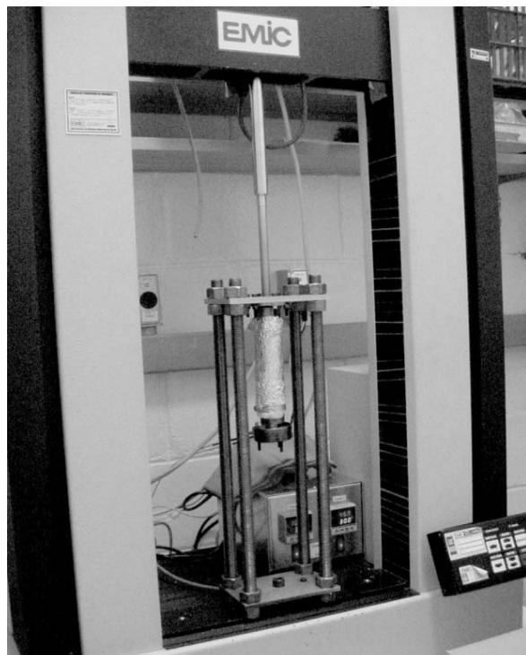
Figura 2. Módulo de Reometria capilar
