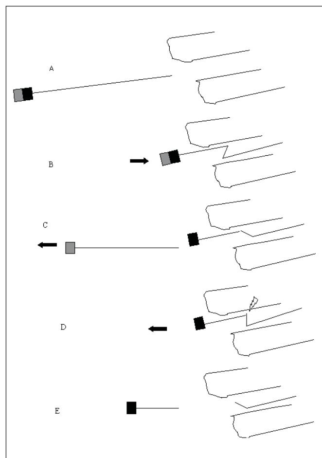
Figura 3 - Desenho Mostrando o Provável Mecanismo de Deformação da Agulha (A, B e C) e de sua Fratura (D e E)
