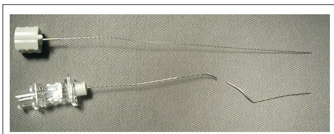
Figura 1 - Agulha de Raquianestesia 27G Quincke (B Braun®) Fraturada e seu Respectivo Mandril Deformado
