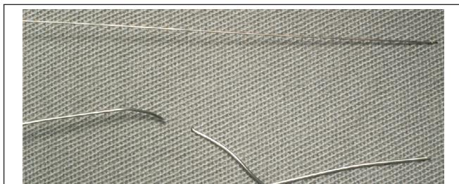
Figura 2 - Detalhe da Agulha de Raquianestesia 27G Quincke (B Braun®) Fraturada a 43 mm de sua Ponta e seu Mandril. Fragmento Distal Retirado após Exploração Cirúrgica da Região do Ligamento Interespinhoso de L<sub>2</sub>-L<sub>3</sub>
