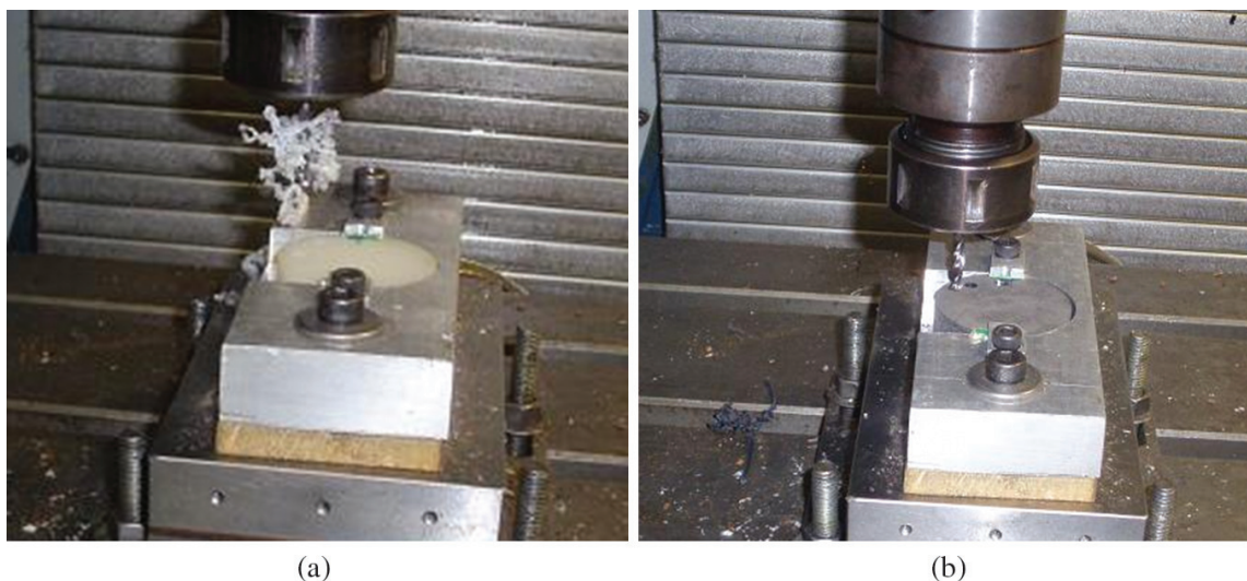
Figura 3. Sistema de fixação dos corpos de prova de poliamida no processo de furação: a) PA6 e b) PA66GF30.
