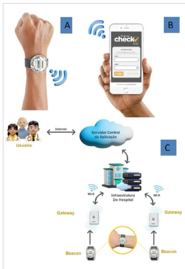
Figura 1A. Ilustração do Beacon, dispositivos BLE. 1B. Ilustração do aplicativo utilizado para associação dos beacons aos pacientes e registro de cada etapa da jornada cirúrgica. 1C. Ilustração do passo-a-passo do sistema de localização Indoor.
