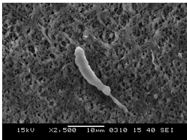
Figura 6 MEV-Portex de filtro plano; ampliação em 2.500x de P. aeruginosa após a infusão bacteriana.
